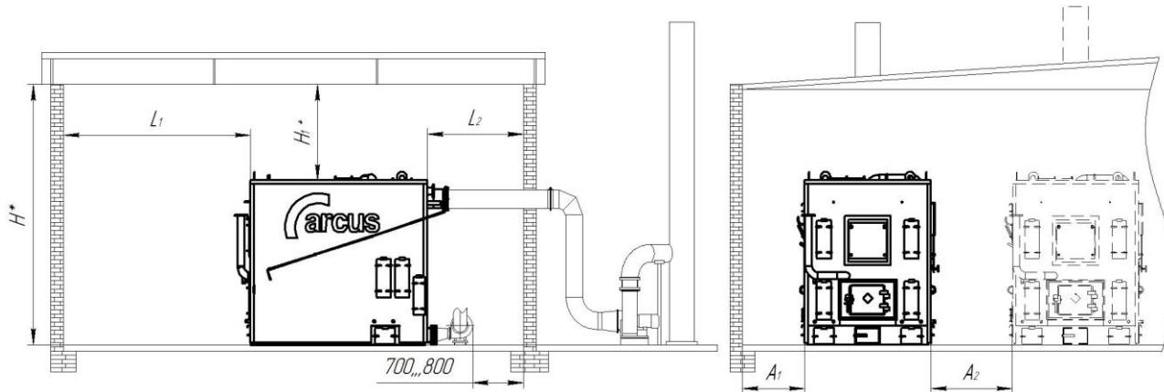
Размеры помещения котельной и установочные размеры отопительных котлов КВм-К
