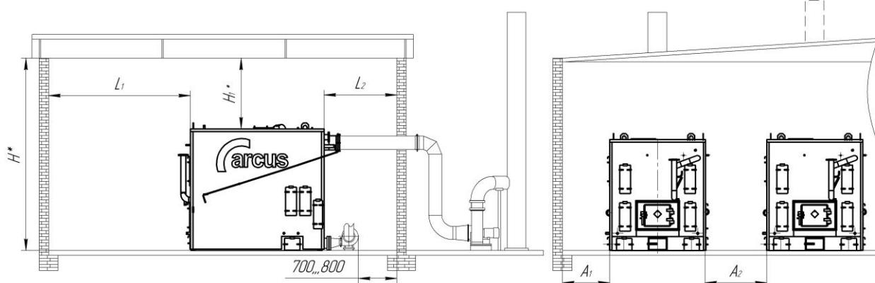
Размеры помещения котельной и установочные размеры отопительных котлов КВр-К
