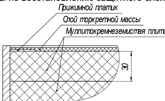
Рисунок 9. Разрез передней крышки.
