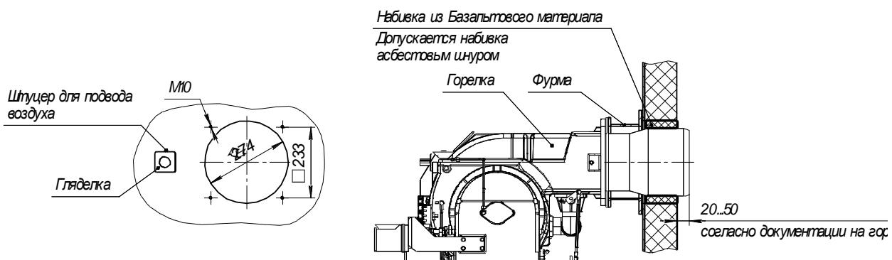
При установке горелки руководствоваться документацией на горелку. Зазор между фирмой и горелкой забить базальтовым волокном.
