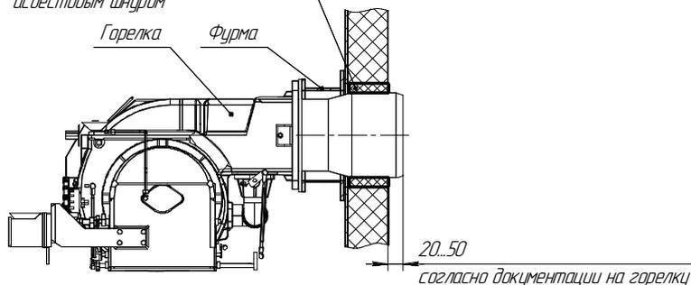
Рисунок 2. Отверстие под горелку
