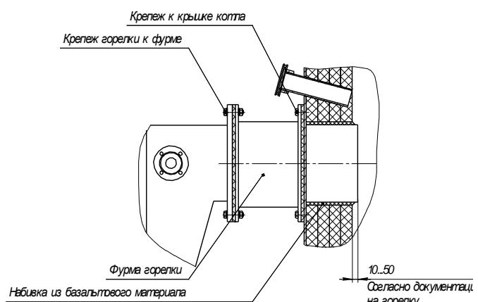
Рисунок 3. Крепление горелки.
