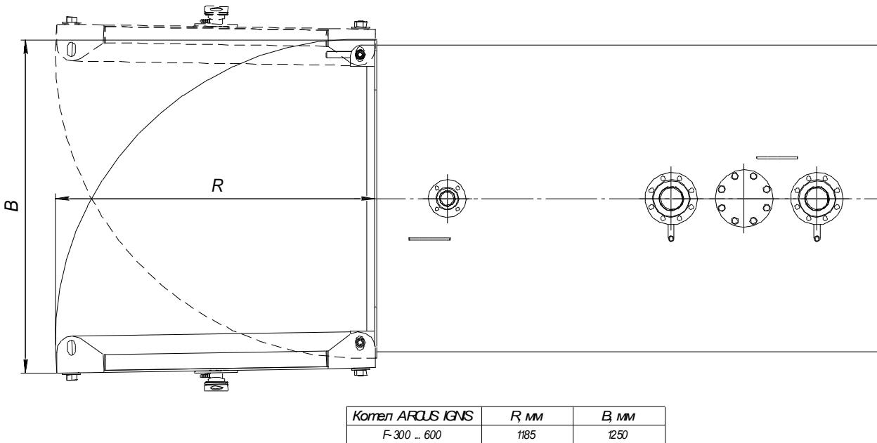
Рисунок 4. Схема открытия крышки.
