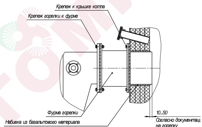
Рисунок 5. Крепление горелки.
