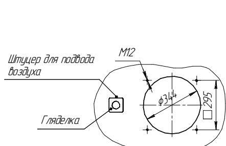
Рисунок 2. Отверстие под горелку
