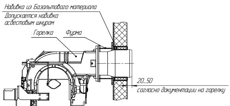
Рисунок 3. Крепление горелки
