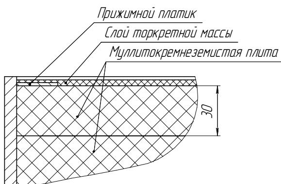
Рисунок 9. Разрез передней крышки.
