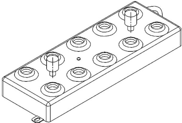
**Рисунок 2.8. Блок ультразвуковых мембран**
