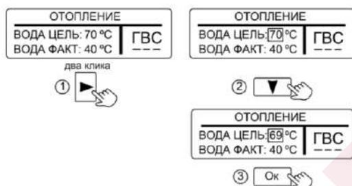
Заводская настройка температуры теплоносителя - **70°C**. Возможно изменение температуры (см. рис. 7).
