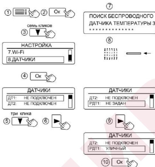
Рисунок 23. Настройка радиодатчиков
