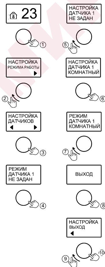
Рисунок 11. Настройка датчиков температуры воздуха
