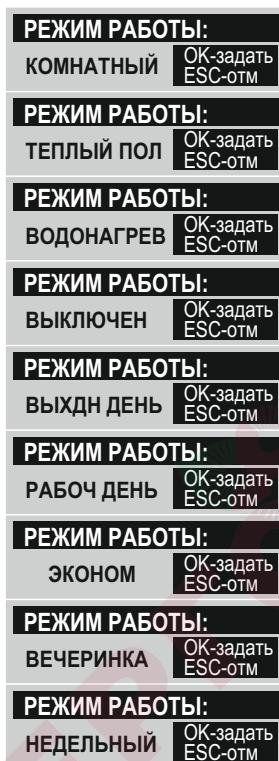
**Рисунок 20. Отображение на экране режимов работы прибора.**
