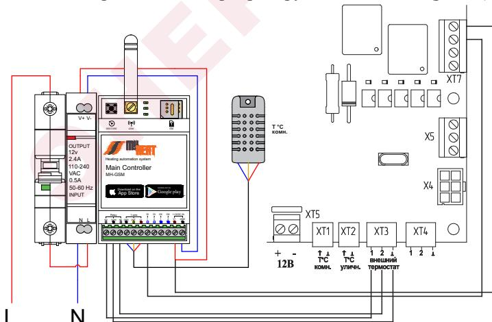
**Рисунок 29. Схема подключения термостата MY HEAT GSM.**
