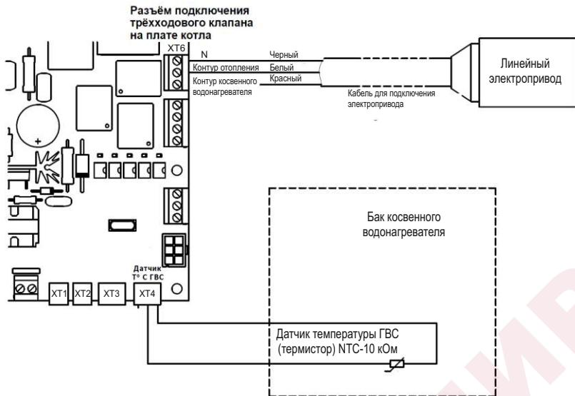
Рисунок 17. Электрическое подключение комплекта ГВС EVAN AQUA.
