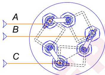
**Подключение секций мощностью 12, 18 кВт**
