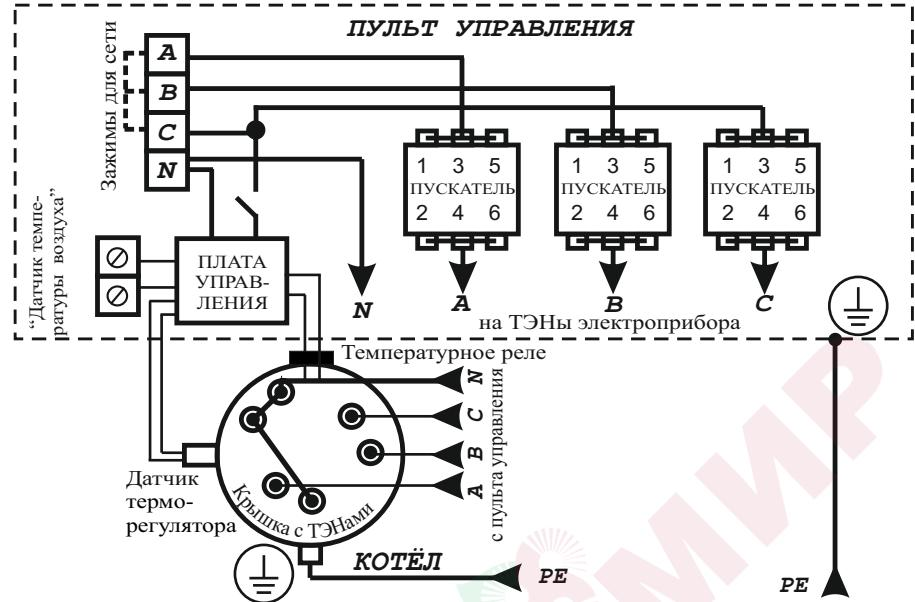
Рисунок 10. Электрическая схема подключения
