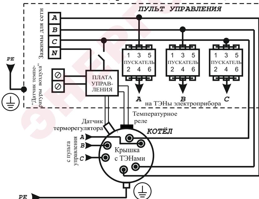
Рисунок 11. Электрическая схема подключения
