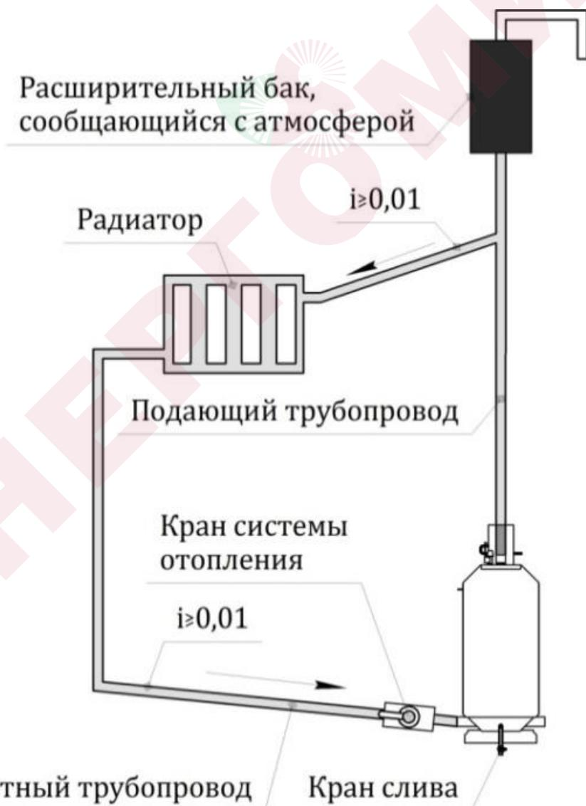
Рисунок 8 – Схема открытой системы отопления с естественной циркуляцией
