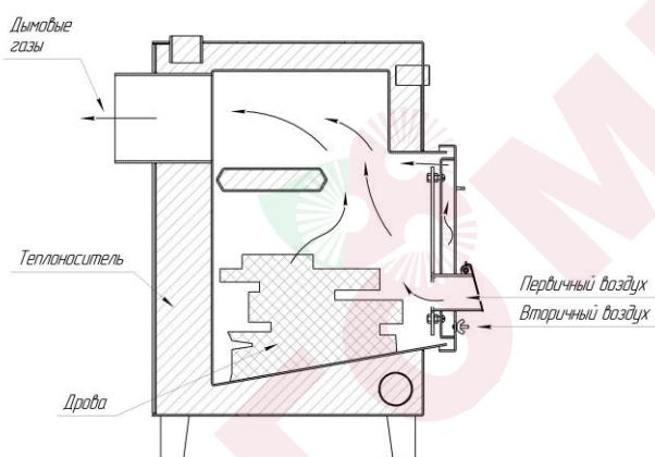
Рисунок 1 - Схема котла
