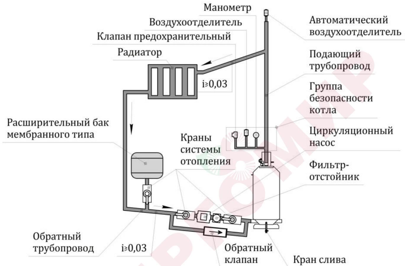
Рисунок 10 – Схема закрытой системы со смешенной циркуляцией
