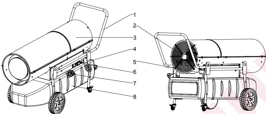
Рисунок 1 - Устройство теплогенератора КХД-120
