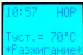
Рисунок 12 – Вид панели управления в режиме РАЗЖИГАНИЕ
