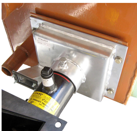
Рисунок 3 – Место установки механизма подачи топлива
