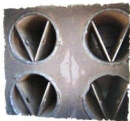
Рисунок 2 – Установка турбулизаторов
