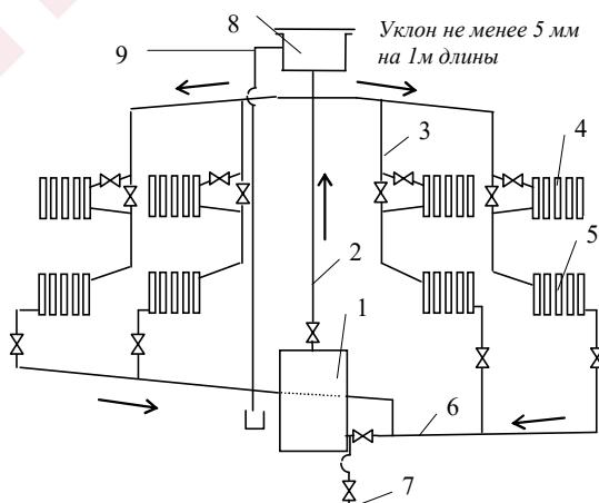
1 - котел; 2 - главный стояк; 3 - стояки; 4,5 - нагревательные приборы 1 и 2-го этажа; 6 - трубопровод обратной воды; 7 - подпиточный водопровод; 8 - расширительный бак; 9 - переливная труба.
