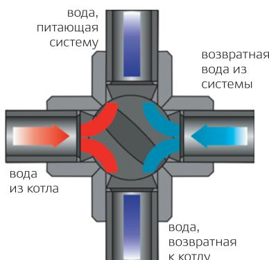
в) система частично открытая – вода, питающаяся из котла, перемешивается с водой из системы центрального отопления
