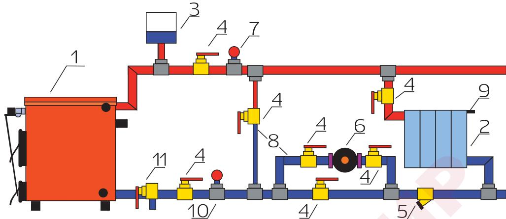
Подключения котла к **двуухтрубной открытой системе** с принудительной циркуляцией теплоносителя:
