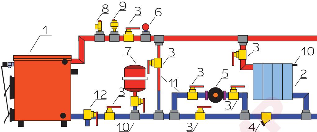
Подключения котла к **двуихтрубной закрытой системе** с принудительной циркуляцией теплоносителя:
