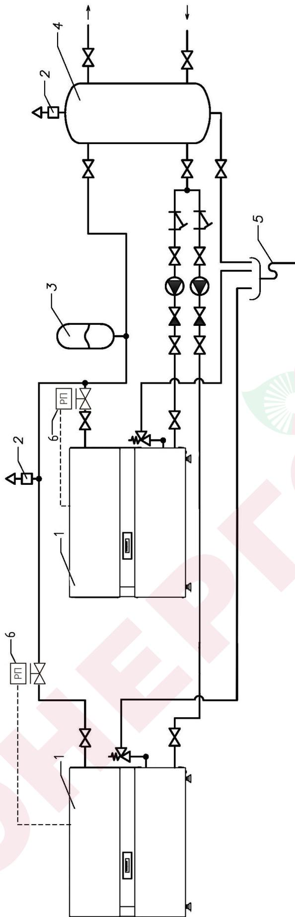
**Рис. 4 Упрощенная схема подключения водонагревателя в систему водоснабжения.**
