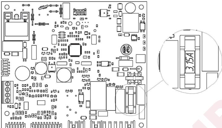
Рис. 11. Расположение предохранителя
