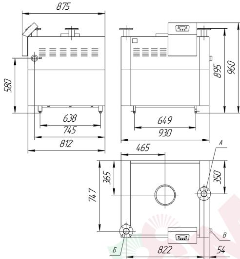
Рис. 2.1. Габаритные и присоединительные размеры котлов Clever L100
