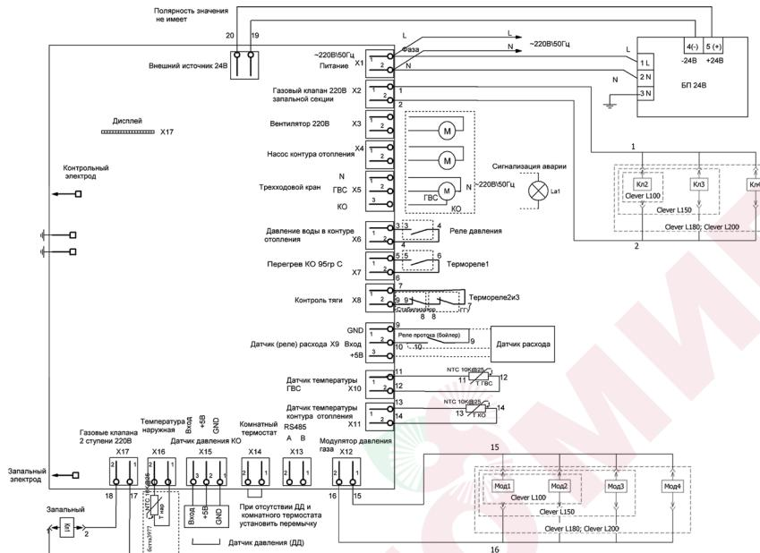
Рис. 7. Схема принципиальная
