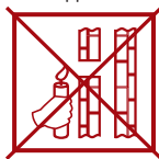
слабая тяга (Не используйте котел!)
