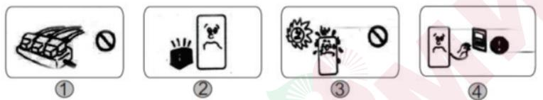
1. Не используйте реле, удлинители или переходники для подключения устройства, в противном случае это может привести к пожару, поражению электрическим током или ожогу.
