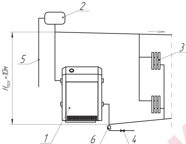
**Рис. 3. Примерная схема открытой системы отопления \***
