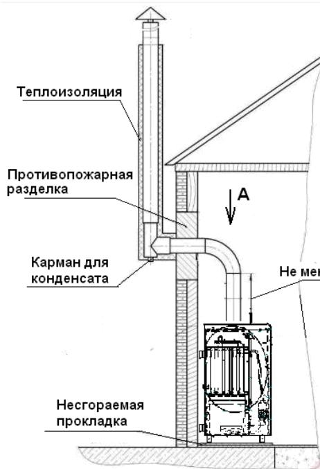
Схема подключения к дымоходу
