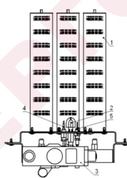
рис.12 Горелки УГ-29S к АОГВ/ АКГВ-23,2-3-2;
