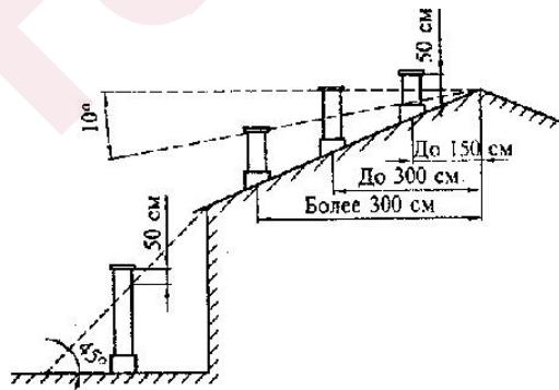
**Схема вывода дымовых каналов на
