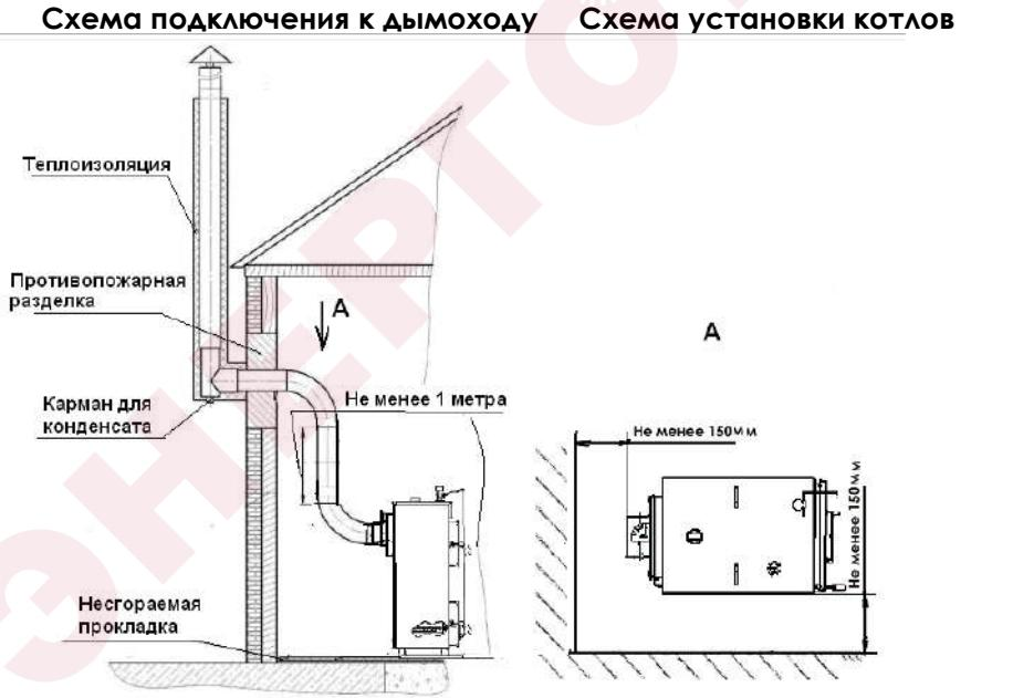
**Схема подключения к дымоходу      Схема установки котлов**
