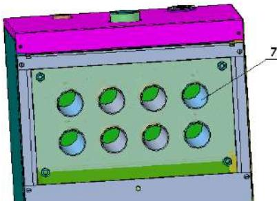
**Рис.14** Установка турбулизаторов
