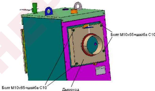
**Рис.5** Крепление дымохода котлов
