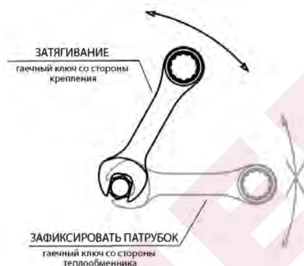
Рис. 5. Подключение к системе подачи теплоносителя
