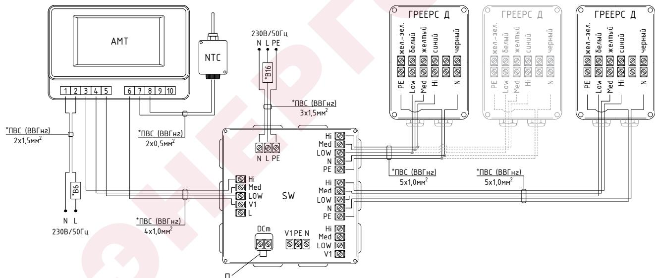
\* Подбор сечения провода и автоматического выключателя осуществляется проектировщиком исходя из количества подключаемых аппаратов
