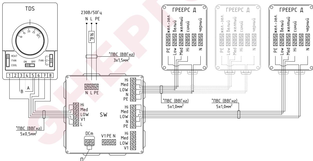
\* Подбор сечения провода и автоматического выключателя осуществляется проектировщиком исходя из количества подключаемых аппаратов
