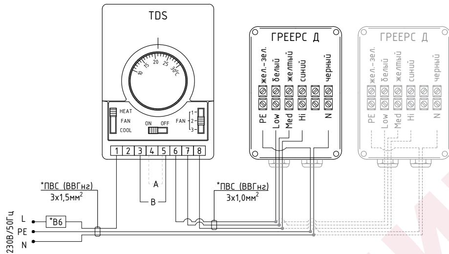
\* Подбор сечения провода и автоматического выключателя осуществляется проектировщиком исходя из количества подключаемых аппаратов
