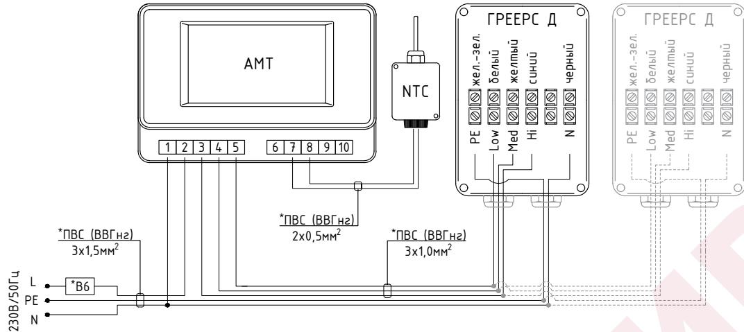
\* Подбор сечения провода и автоматического выключателя осуществляется проектировщиком исходя из количества подключаемых аппаратов
