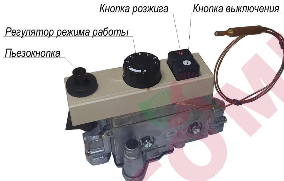
Рисунок 7.1 – элементы управления газового клапана с пьезорозжигом
