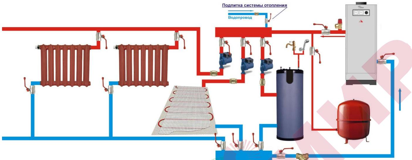
Рисунок 6. Схема подключения котла с общим коллектором
