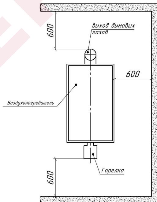
**Рисунок 13. Минимально допустимые расстояния. Размеры указаны в мм**
