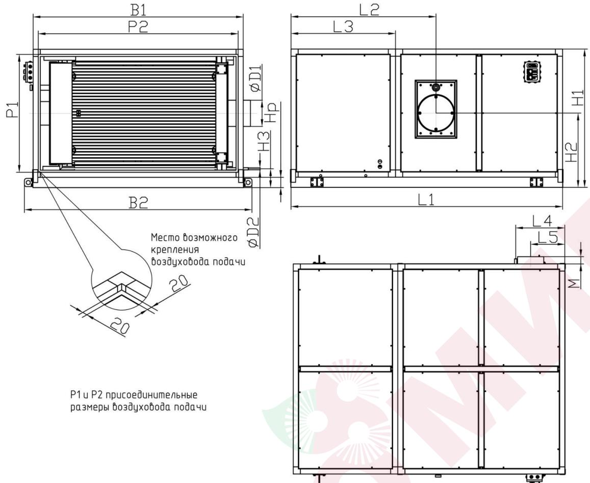
**Рисунок 8. Габаритные размеры воздухонагревателя TITAN Air VSHp горизонтального исполнения (с секцией вентиляции, подача воздуха "вправо") (см. Таблицу 4)**
