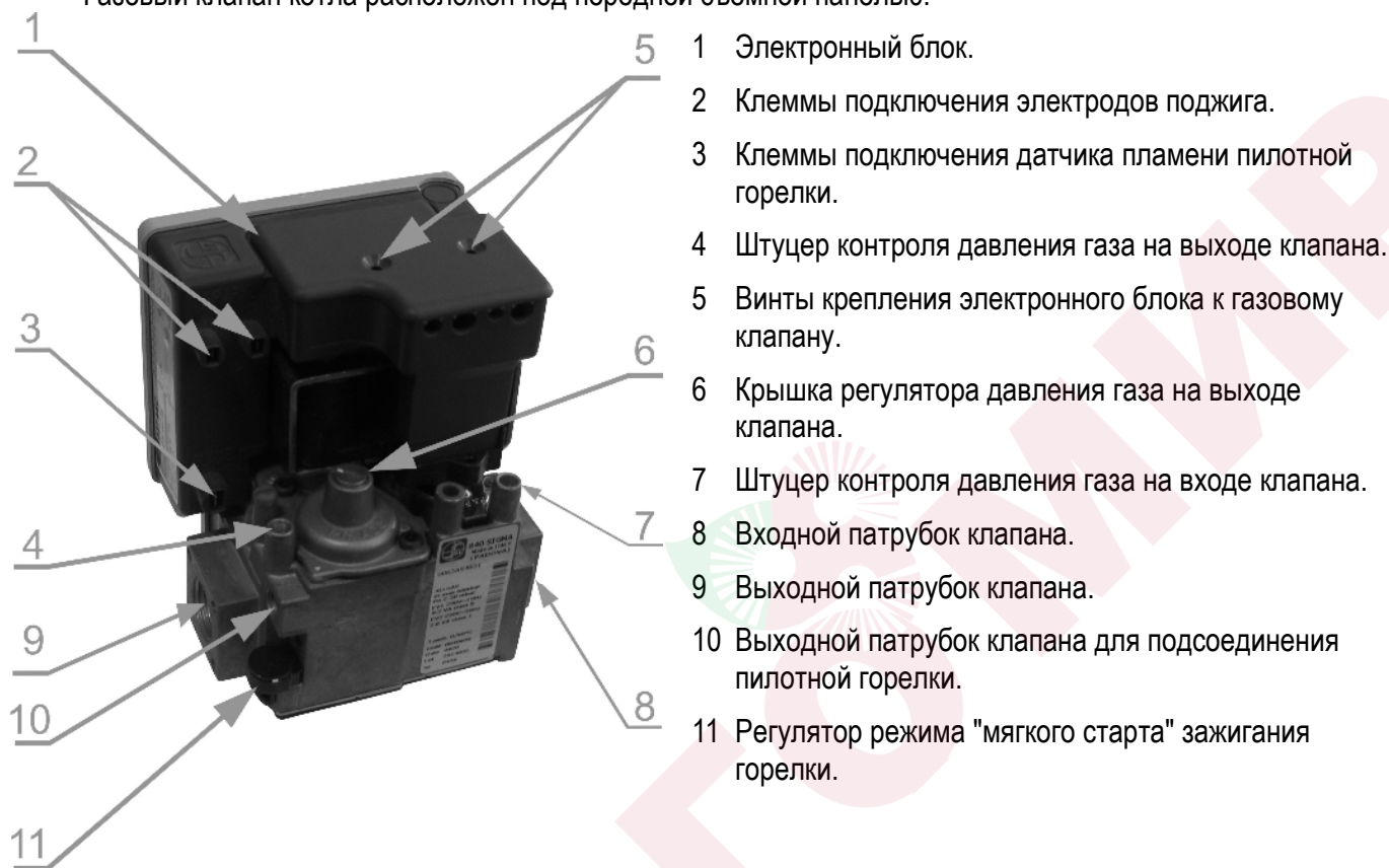
Рисунок 10. Газовый клапан котла с автоматикой.
