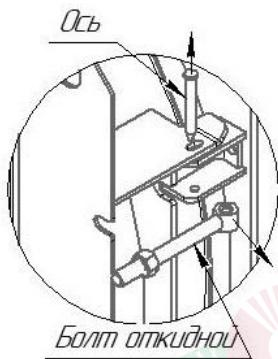
2) Вынуть крепежную ось, снять откидной болт
