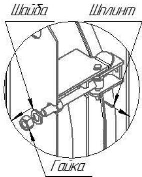
1) Открутить гайку и снять шайбу с откидного болта, вынуть шплинт снизу крепежной оси
