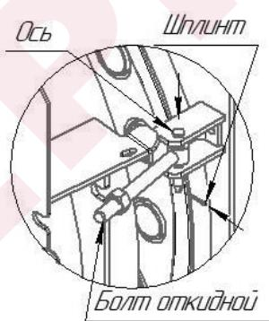
4) При открытой двери, установить обратно откидной болт и вставить крепежную ось, зафиксировать ось шплинтом
