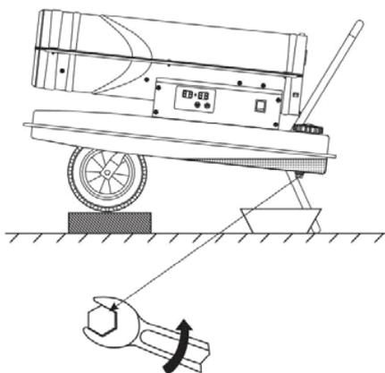
По окончании каждого цикла остаток топлива из бака следует сливать. Затем очистите внутреннюю поверхность бака чистым дизельным топливом или керосином. Регулярно проводите чистку топливного бака по мере необходимости.
