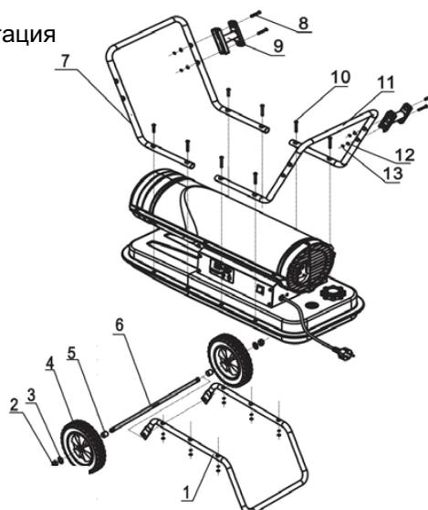
1. Вставьте ось 6 через соответствующее отверстие в опорную трубку 1. Затем установите ограничительную втулку оси 5, колесо 4 и шайбу 3 с обоих концов вала 6 и зафиксируйте при помощи гайки 2.
