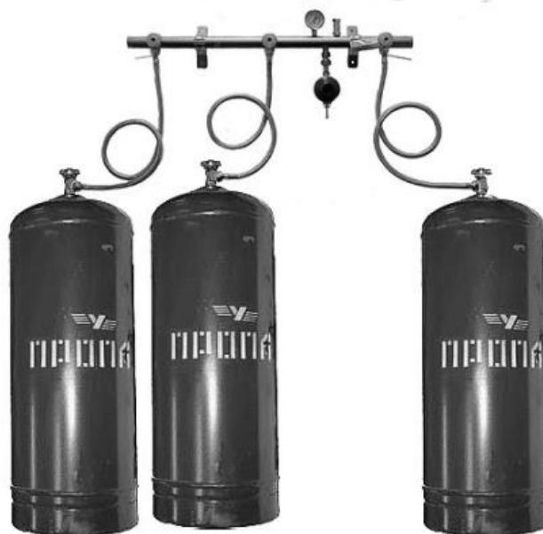
Рис. 17 Баллонная установка из трёх баллонов объёмом 50 л. с коллектором и редуктором (регулятором давления газа).
