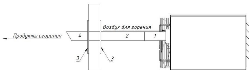
Горизонтальный одностенный дымоход. 16/20/28/35 ТН, 20/28/35 ТС. D: Ø80. AISI 304
