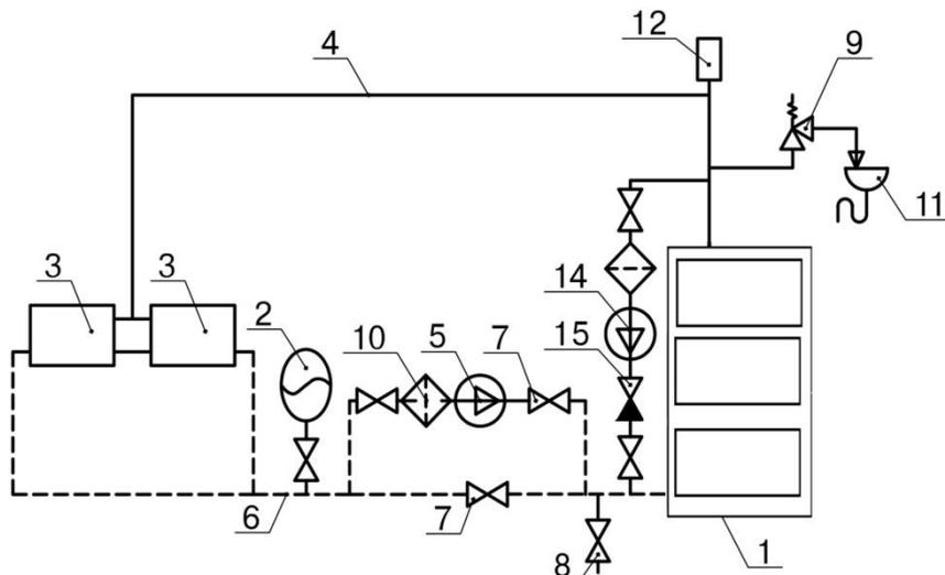
(1.Твердотопливный котел MASTER, 2.Расширительный бак, 3.Прибор отопления, 4.Подающий трубопровод, 5.Циркуляционный насос, 6.Обратный трубопровод, 7.Запорный кран, 8.Дренажный кран, 9.Предохранительный клапан 3bar, 10.Фильтр сетчатый, 11.Канал сброса излишков теплоносителя, 12.Автоматический воздухоотводчик, 14.Циркуляционный насос, 15.Клапан обратный).
