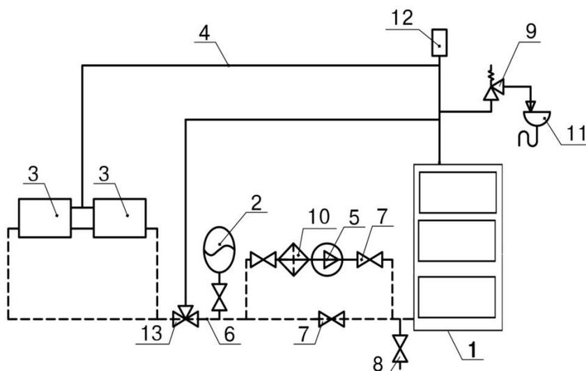
(1.Твердотопливный котел MASTER, 2.Расширительный бак, 3.Прибор отопления, 4.Подающий трубопровод, 5.Циркуляционный насос, 6.Обратный трубопровод, 7.Запорный кран, 8.Дренажный кран, 9.Предохранительный клапан 3bar, 10.Фильтр сетчатый, 11.Канал сброса излишков теплоносителя, 12.Автоматический воздухоотводчик, 13.Трехходовой смесительный клапан, 15.Клапан обратный).
