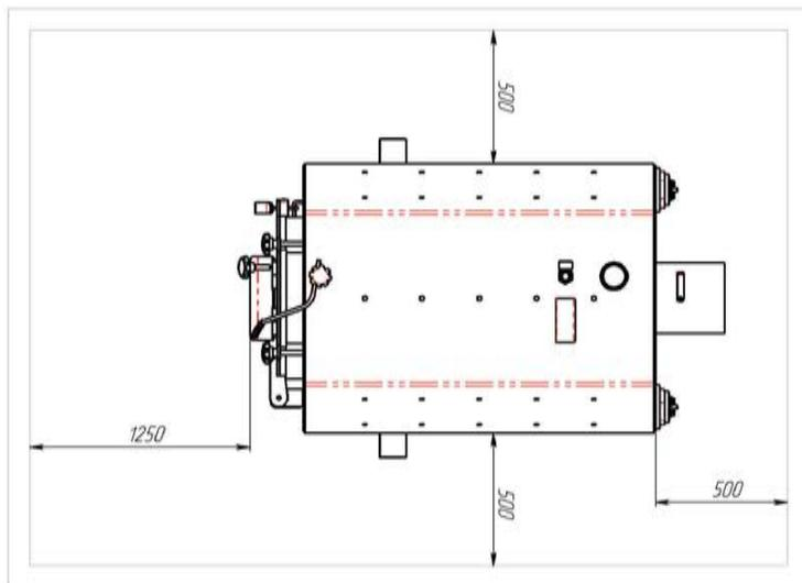
Такая установка котла обеспечит лёгкий доступ к его отдельным частям, что необходимо для его правильной эксплуатации и консервации. Когда это требование невыполнимо, такие поверхности должны быть защищены листовым асбестом или войлоком, смоченным в глиняном растворе. Поверх этого слоя укладываются стальные листы. Перед топочной дверцей на сгораемом или трудно сгораемом полу необходимо предусмотреть металлический лист не менее 0,7x0,5 м.
